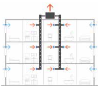
MFH / zentrales Lüftungsgerät
