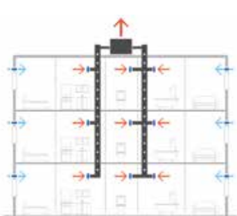
MFH / zentrales Lüftungsgerät
