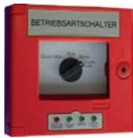
Betriebsartschalter für Überdruck-Belüftungssteuerung aus Kunststoff mit Glasschutzscheibe. Der Schalter hat absolute Priorität. Alle sonstigen Steuerorgane sind nachrangig. Bei Unterbrechung der Verbindungsleitung wird maximaler Überdruck ausgelöst.
