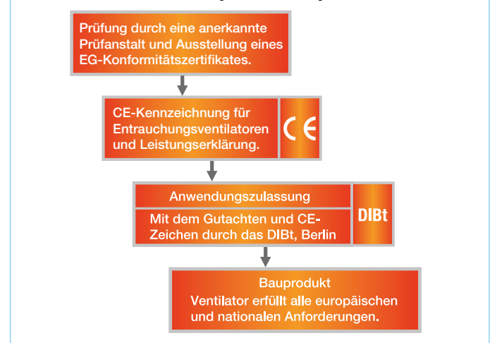
Bild 5 Bauaufsichtliche Anforderungen an Entrauchungsventilatoren
