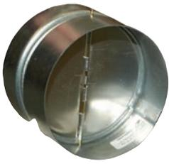
Die RSK Rückschlagklappe ist aus verzinktem Stahlblech hergestellt. Die beiden Klappen sind mit Federn ausgestattet, so dass diese auch vertikal montiert werden können.
